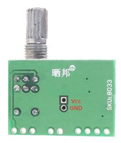
Dieser Anschluss wird zur Versorgung des ESP32 und des Displays verwendet, damit man über das Potentiometer, das Gerät komplett ausschalten kann.
