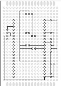
Die Abbildung zeigt die Bestückung und die Verdrahtung auf der Unterseite
